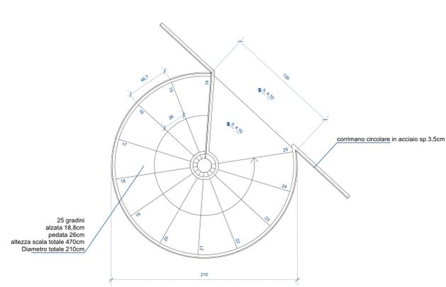
DETTAGLIO SCALA PIANO PRIMO - SCALA 1:20
