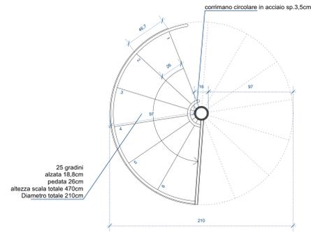
DETTAGLIO SCALA PIANO TERRA - SCALA 1:20
