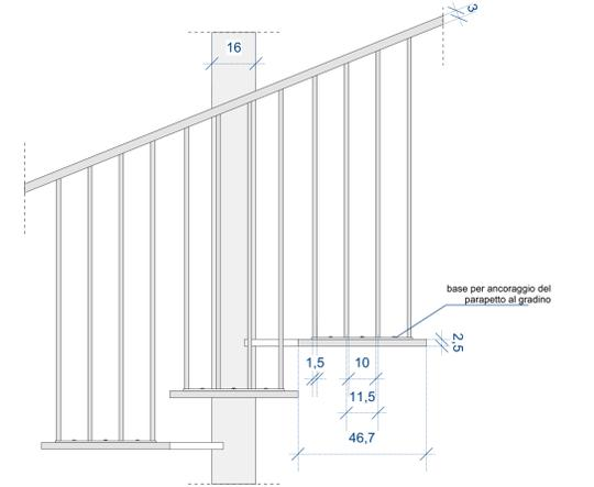
DETTAGLIO ANCORAGGIO PARAPETTO-GRADINO - SCALA 1:10
