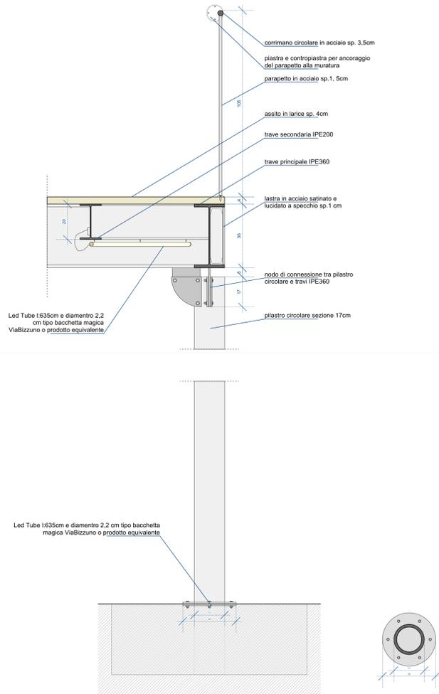
DETTAGLIO SEZIONE VERTICALE DEL SOLAIO : SCALA 1:10
